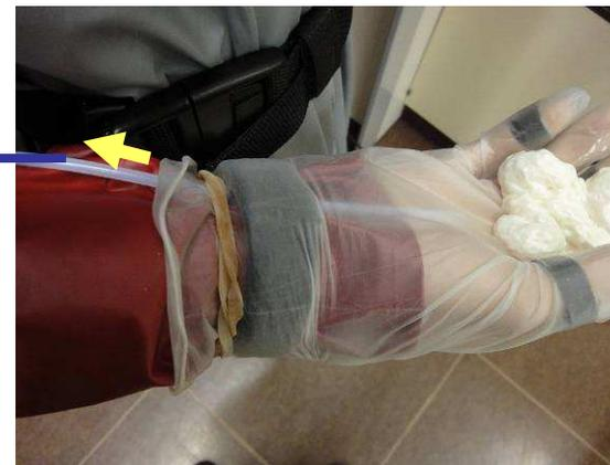
**Frischluft-Zuführung, zum Ausgleich der zwecks Analyse entnommenen Luft, an die Fingerkuppen der Hand.**
