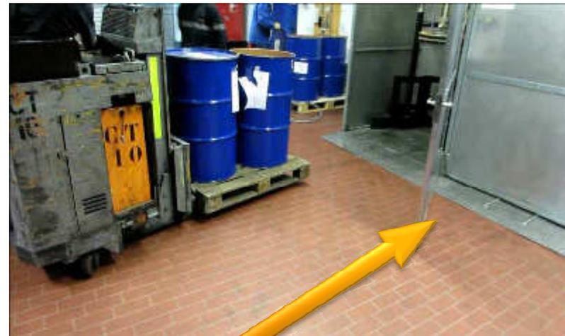
Die Fettpresse wurde höher gesetzt und mit einer Führung zum Zentrieren der Fettfässer ausgestattet, sodass die Fässer auf Paletten mittels Flurförderzeug gewechselt werden können.
