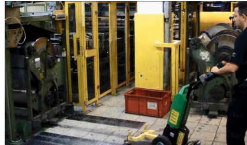
Durch den Einsatz des Movexx sind die Gewichte aus dem Arbeitsvorgang eliminiert. Lediglich die Kraft und Konzentrationsanforderung für das Lenken sind weiterhin notwendig.
