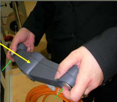
3. Schritt: Anschließen des Handterminals
