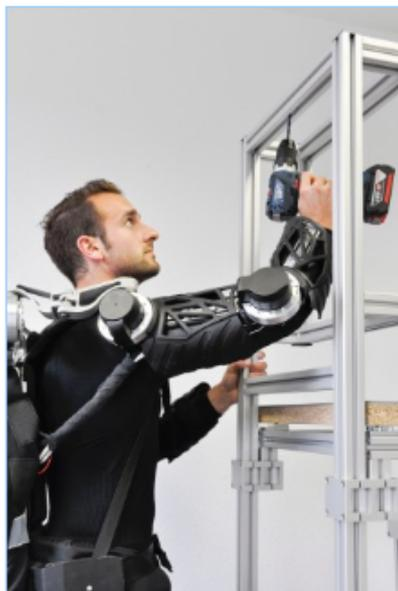
Exoskelett zur Entlastung bei Überkopfarbeiten. (Foto: Ludmilla Parsyak © Fraunhofer IPA)
